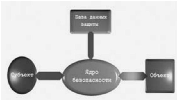
**Рис. 2. Классическая модель ядра безопасности**
