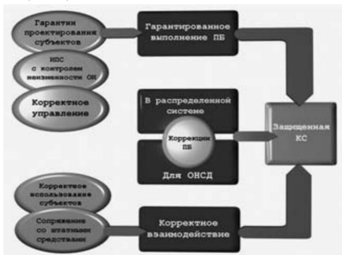
Рис. 1. Взаимосвязь методов проектирования защищенной КС
